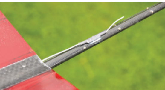
Die winzigen Führungen für die Gestänge sind sensationell sauber aufgeklebt. Auf dem Rücken habe ich hier den Antennenverstärker des AR400-Empfängers befestigt.
