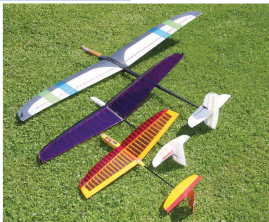
Schleudersegler im Größenvergleich von oben nach unten: 1,5-m-Steigeisen, 1,0-m-ELF und 60-cm-Birdy.
