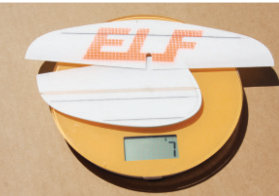
Hauchzarte Glasseide mit Kohleholmen und Elastic-Flap. In Wahrheit wiegt das Leitwerk nur 5,5 g – das kann aber die Küchenwaage gar nicht mehr auflösen.
